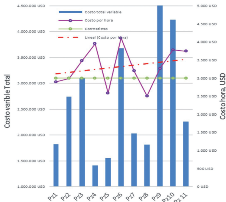
Figura 6. Costo variable de perforación total y por hora.
