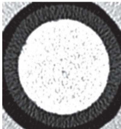
**Figura 3.b.** Sección de la muestra completamente saturada con agua de formación a 80 kV.
