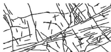
FIGURA 2. Ejemplo de trazas de fracturas. Las trazas se miden manualmente y se calculan los parámetros indicados. A = área de la imagen; D = densidad de las microfrazuras. Tomado de Samaniego et al. , (2003).
