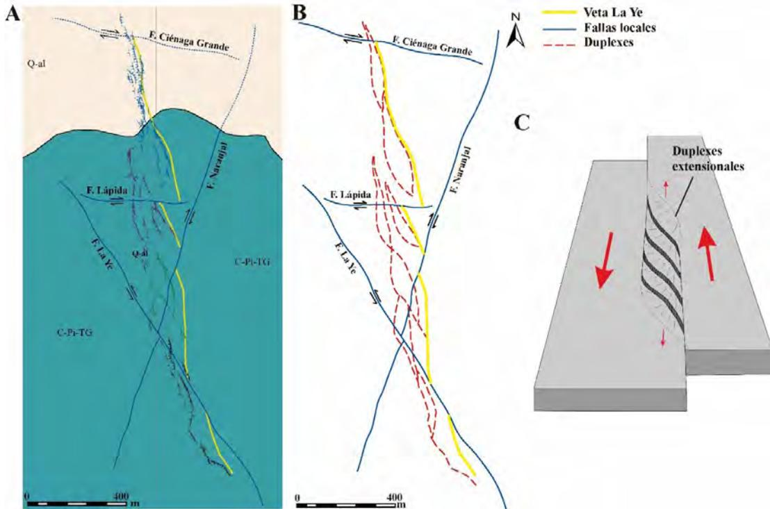
**Figura 10.** Esquema explicativo de la posible generación de duplexes al interior de la zona de cizalla. **A.** Espacialización del segundo orden. **B.** Esquema de posibles duplexes formados a lo largo de la zona de estudio. **C.** Esquema de zona transtensional donde se generan duplexes en una cizalla sinistral (modificado de Fossen, 2016).
