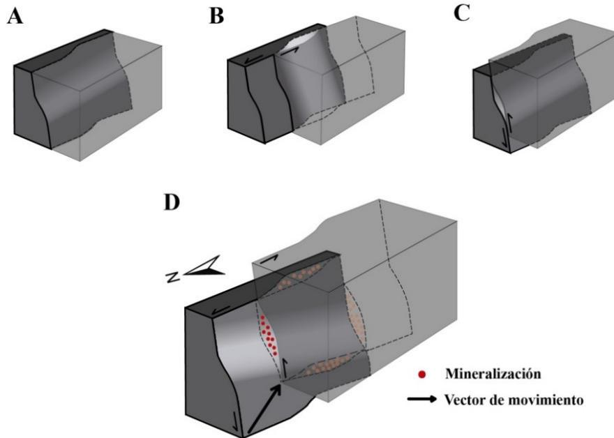
**Figura 9.** Esquema de formación de estructuras dilatacionales a partir de variaciones en el rumbo y buzamiento en el evento D3. **A.** Zona de fractura con curvatura izquierda sin desplazamiento. **B.** Movimiento sinistral que genera curvatura dilatacional en rumbo. **C.** Movimiento inverso que genera curvatura dilatacional en buzamiento. **D.** Transpresión sinistral que genera zona dilatacional con componente en rumbo y buzamiento.
