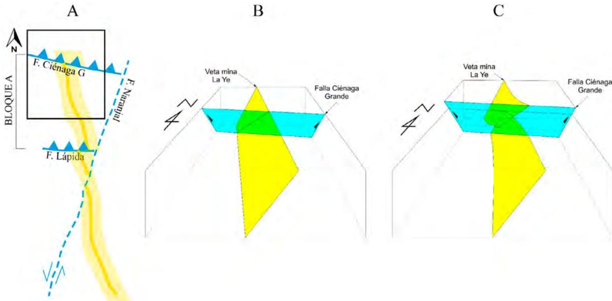
**Figura 7.** Modelo explicativo para la verticalización del bloque A. **A.** Vista planta. **B.** Bloque diagrama de la veta La Ye y la falla Ciénaga Grande sin desplazamiento. **C.** Bloque diagrama de la veta La Ye y la falla Ciénaga Grande con desplazamiento, se puede observar la verticalización al norte de la veta.
