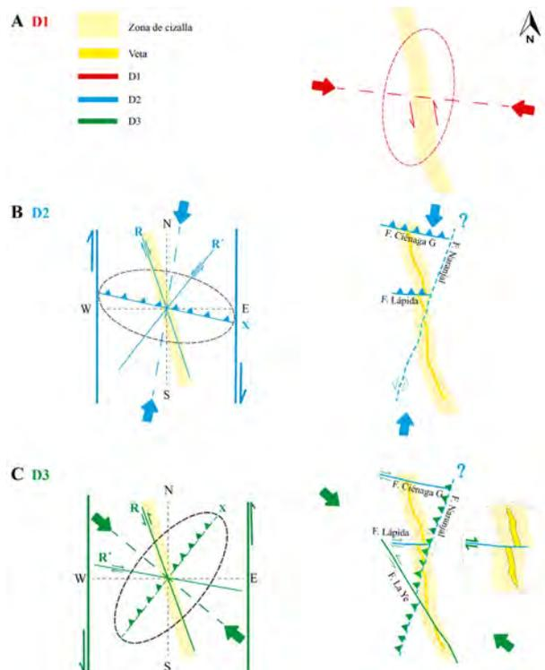
**Figura 4.** Esquema ilustrativo de eventos deformativos. A. Transpresión sinistral con compresión SEE-NWW, D1 (Starling, 2015). B. Transpresión dextral con compresión NNE-SSW, D2. C. Transpresión sinistral con compresión NW-SE, D3.
