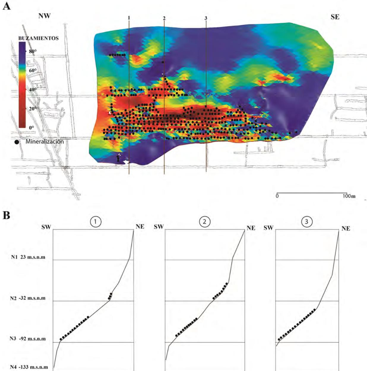
**Figura 5. A.** Face-Dip vista frontal para el bloque C, mina La Ye. **B.** Perfiles verticales donde se aprecia la existencia de altos tenores relacionados a la inflexión del buzamiento de la estructura.
