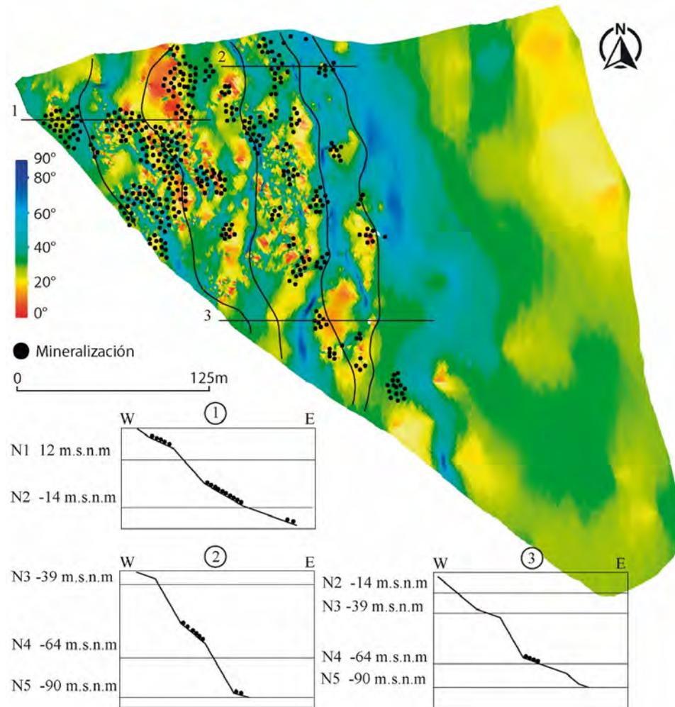
**Figura 6.** Face-Dip vista en planta para el bloque E, mina Mangos. Se observa la poca o nula existencia de altos tenores en las zonas de alto ángulo de buzamiento y al contrario, la existencia de éstos, en las zonas de menor buzamiento.
