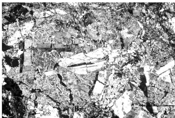
**FIGURA 8.** Cristales de plagioclase con recristalización dinámica por migración de borde de granos (Mbg) y algunos cristales con extinción ondulatoria de barrido (Eob). En la parte central de la imagen se presenta un cristal de plagioclase microfallado y con macla de deformación. Nícoles cruzados. Muestra GO-10C.
