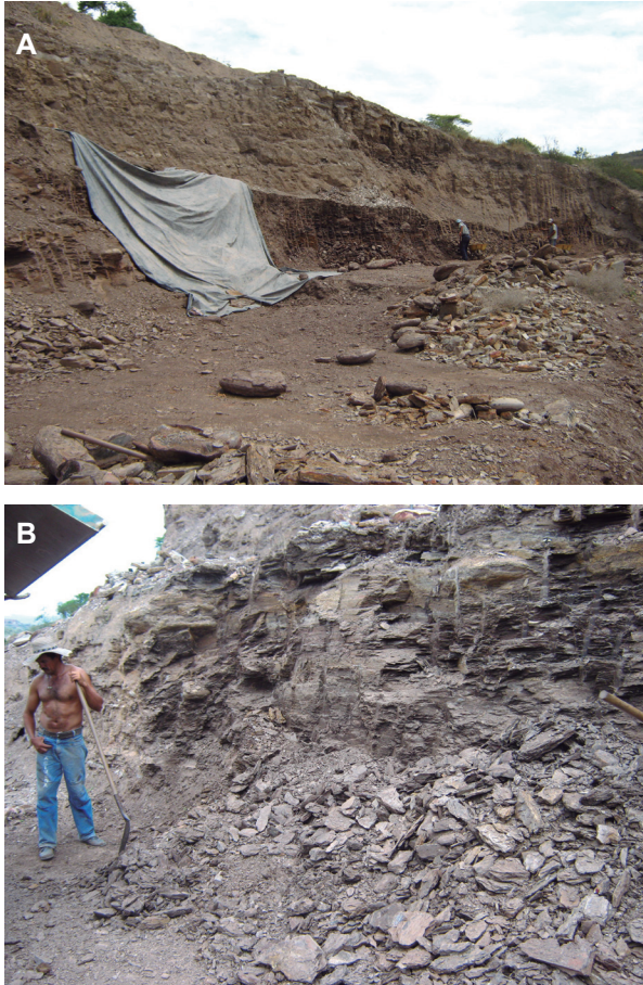
FIGURA 5. Sitio de explotación. A: vista general, se observa la posición subhorizontal de los estratos. B: vista de detalle; en la parte superior derecha las concreciones de caliza, debajo de ellas niveles con mineralización de sales de potasio.
