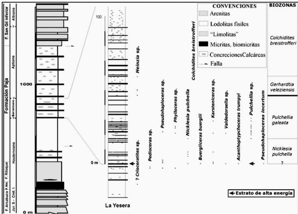
FIGURA 2. Sección estratigráfica generalizada de Villa de Leyva con detalle del nivel de lodolitas abigarradas de la Formación Paja en la Loma de La Yesera. Se observa la posición estratigráfica del estrato de alta energía y la distribución estratigráfica de algunas especies de amonitas mencionadas en el texto.
