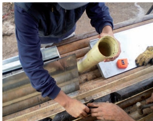
FIGURA 3. Toma de la muestra de carbón de perforación e introducción en el cánister.
