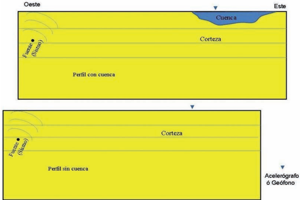
FIGURA 6. Abajo: Ejemplo de un perfil de capas horizontales para modelo 1D (corteza) sin cuenca y, arriba: un perfil de capas horizontales con cuenca.
