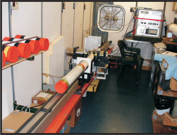
FIGURA 8. (a) Multi Sensor Track System. Cada sección de 1.5m de corazón es sometida a este análisis el cual incluye medidas de resistividad, Rayos Gamma, Susceptibilidad magnética, Temperatura y Velocidad de Ondas P. (b) Resultados de las medidas hechas por la herramienta de Multi System Track para una de las secciones recuperadas
