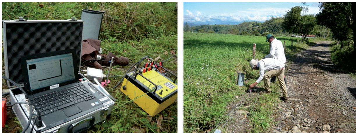
FIGURA 10. Fotografías del trabajo en campo a) Funcionamiento Mini Sting y SACE. b) Tendido de la línea eléctrica en el sector de El Chaquiro.
