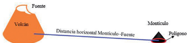
FIGURA 3. Esquema de medición de los parámetros para cada montículo. Tomado de Yoshida et al. (2012).
