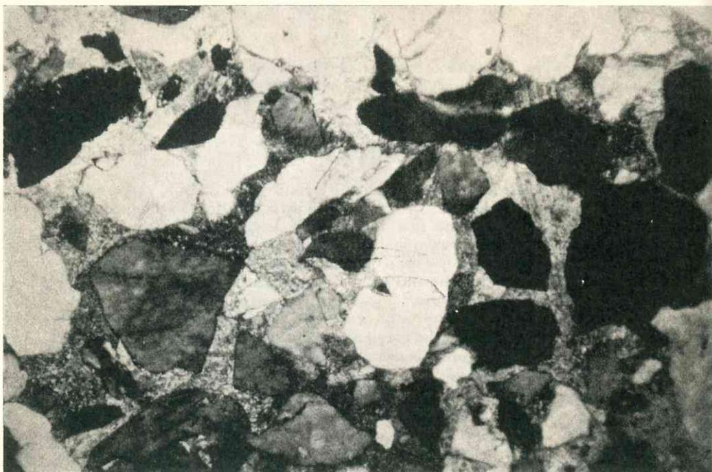
Lámina I; Foto 1. — Aspecto microscópico de una capa de la Arenisca de Labor con abundante cemento de calcita, los granos de cuarzo aparecen flotando en el cemento, en este se observan en algún punto las líneas de exfoliación de la calcita (muestra 478, nicoles cruzados, x 130). (Foto Mesa).
