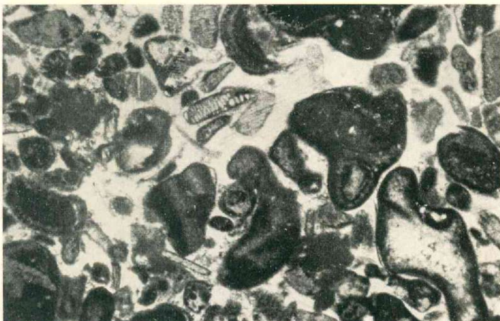
Lámina I; Foto 2. — Bioesparita con oolitos e intraclasts del nivel de esparita en que se observan fragmentos de fósiles bien redondeados, intraclasts y algunos oolitos. El cemento es de esparita (muestra 627, sin analizador, x 30). Foto Meza.
