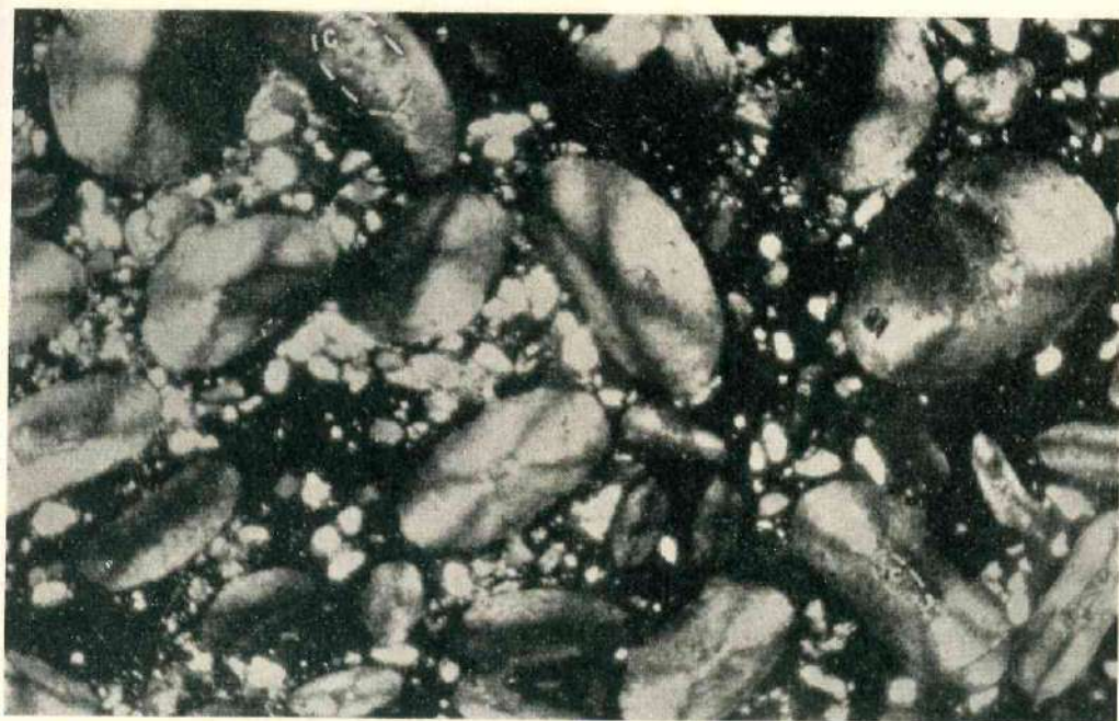
Lámina III; Foto 1. — Parte superior del banco de oolitos ferruginosos; en algunos de los oolitos se observa el núcleo de chamosita (c); junto a los oolitos hay cuarzo detrítico, la matriz es ferruginoso-calcárea (muestra 709, nicoles cruzados, x 40). Foto Meza.
