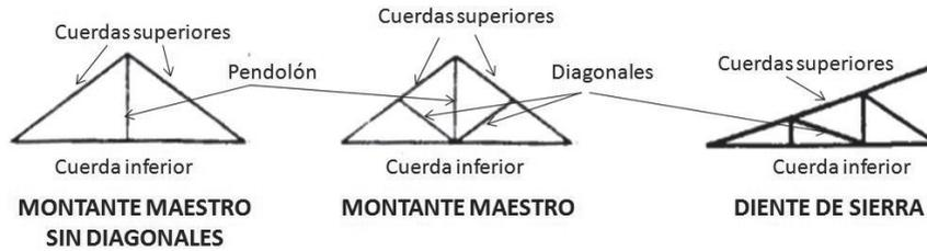
FIGURA 7. Armaduras de madera típicas en la zona de influencia de Galeras para cubiertas liviana-moderada y pesada (Tomado de Torres, 2001).
