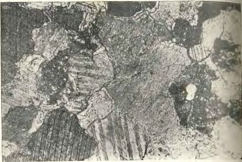
FOTO 23.—Detalle del mosaico de calcita. Los granos de calcita presentan una textura cuarcítica y en los bordes signos de corrosión. Se aprecian signos de una sustitución (en una textura cuarcítica) por calcita. Miembro Zaragoza (Formación Cimarrona), Carretera Honda-Guaduas. Muestra No 207.
