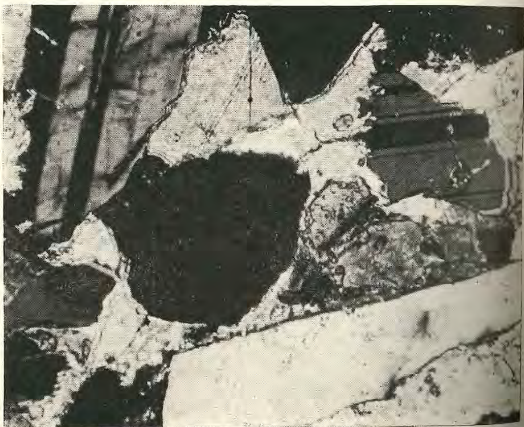
FOTO 36.—Sección de un nódulo arcósico. Los granos flotan en un cemento de calcita. Los granos de plagioclasas presentan los bordes festoneados. Miembro Flor Colorado (Formación San Antonio). Carretera Honda-Guaduas.
