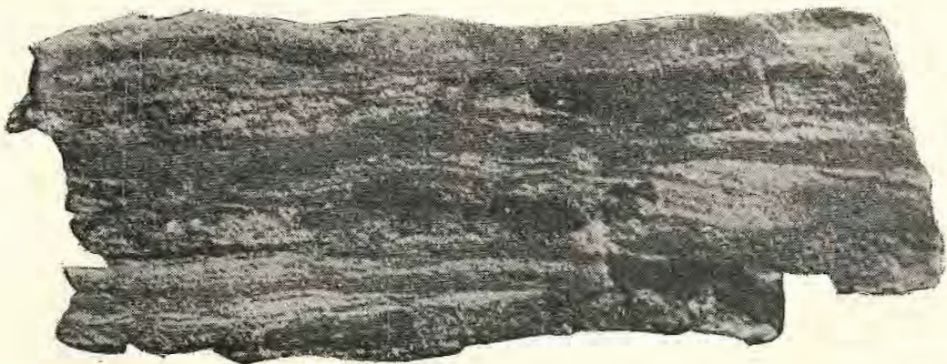
FOTO 10. Microestratificación en una arenita del Miembro La Fría. Las láminas oscuras son muy ferruginosas y corresponden a un limo. Las láminas claras son de grano más grueso y presentan textura cuarcítica. Carretera Honda-Guaduas.
