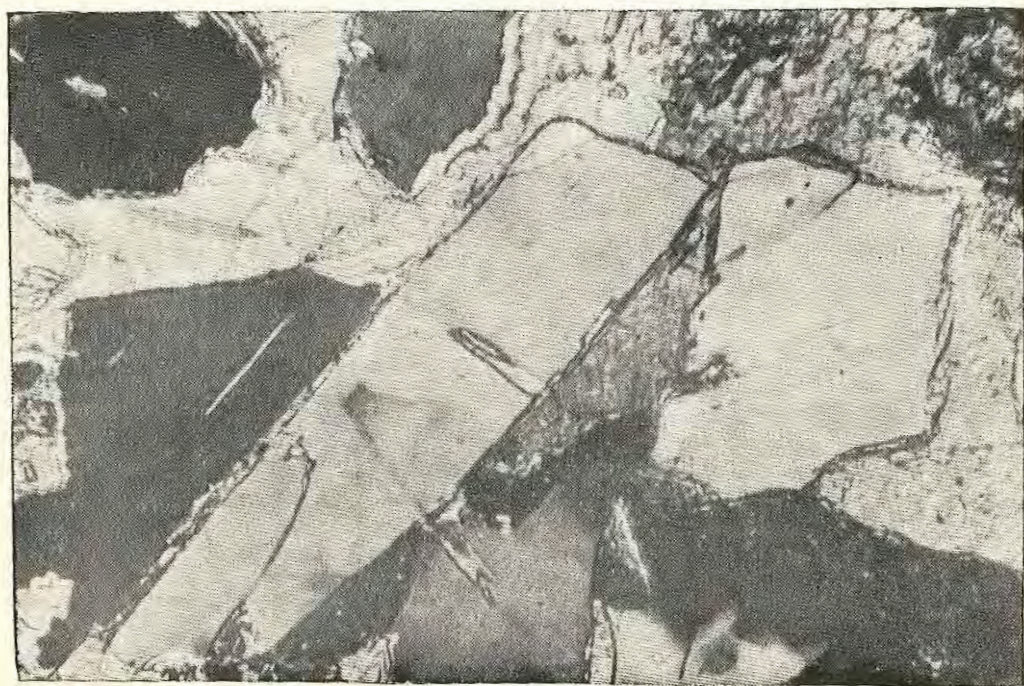
FOTO 11.—Granos de cuarzo, chert y fragmentos de roca flotando en un cemento de calcita. Se aprecia una notable corrosión del cuarzo. Miembro La Fría (Formación Cimarrona). Carretera Honda-Guaduas. Muestra N° 59.
