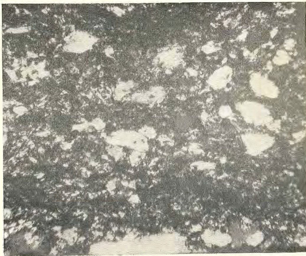
FOTO 26.—Ortoquarcita con estructuras laminares. Separación nítida entre las láminas. Miembro La Primavera (Formación Cimarrona). Carretera Honda-Guaduas. Muestra N° 231.
