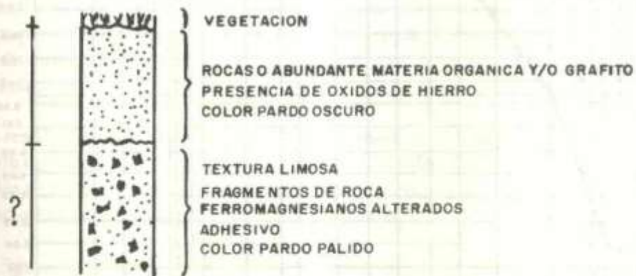
Figura 6. Perfil generalizado de los suelos derivados de la unidad metamorfica
