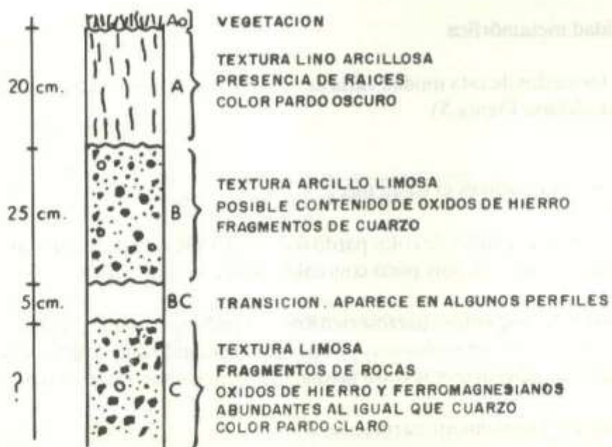
Figura 4. Perfil generalizado de los suelos derivados de la unidad sedimentaria
