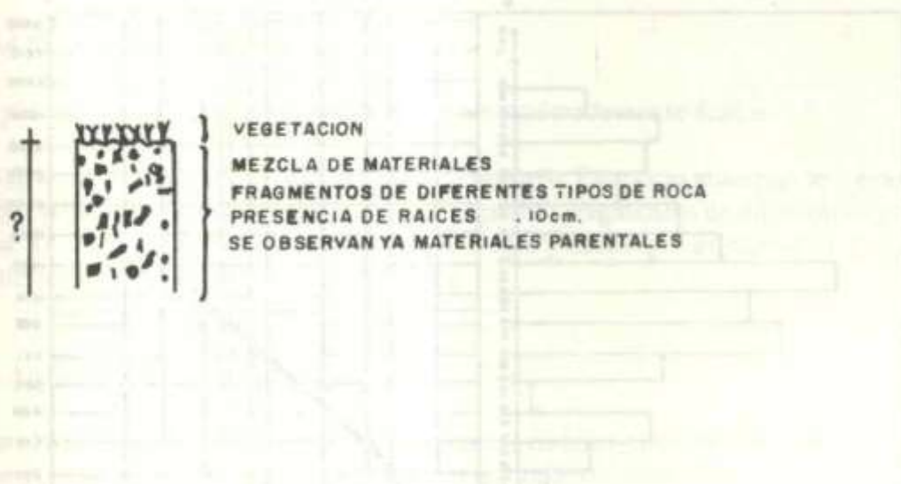
Figura 5. Perfil generalizado de los suelos derivados de la unidad coluvia-aluvial
