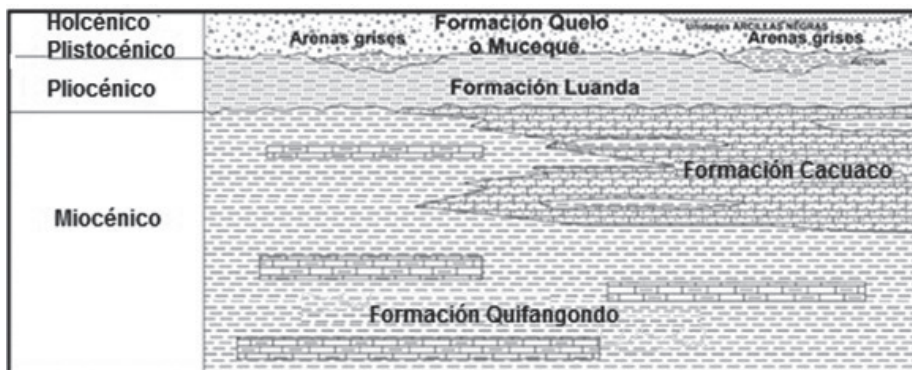
FIGURA 2. Esquema geológico estratigráfico de la ciudad de Luanda, Angola (modificado de Tecnasol, 2007).
