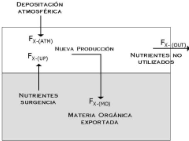
**FIGURA 4.** Modelo 1: Esquema del flujo de nutrientes (FX), hacia dentro y fuera de la zona eufótica (caja azul).  $F_{X-(ATM)}$ =flujo de x desde la atmósfera;  $F_{X-(UP)}$ =flujo de x por surgencia de aguas sub-superficiales,  $F_{X-(OUT)}$ =flujo de x hacia fuera de la caja,  $F_{X-(MO)}$ =flujo de x consumido por la materia orgánica.
