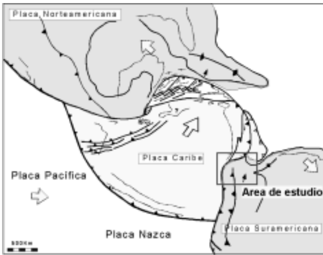
FIGURA 5. Movimiento de las Placas Caribe, Norte y Suramericana en el Cretáceo Superior a Eoceno Superior. El movimiento de las placas está señalado por las flechas. La Placa Caribe mantiene su movimiento con pocas variaciones desde el Cretáceo Superior hasta el Eoceno Superior (Pindell, 1998).
