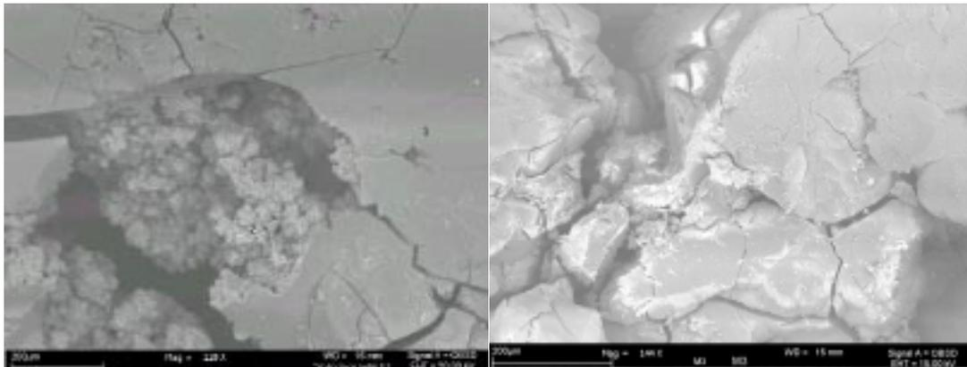
**FIGURA 4.** a) Aspecto al SEM de los agregados botroidales de alofana (punto 2), dentro de una masa amorfa del mismo material (punto 1) y; b) otra imagen al SEM de la alofana, con un desarrollo importante de microfracturas de tipo concoidal.
