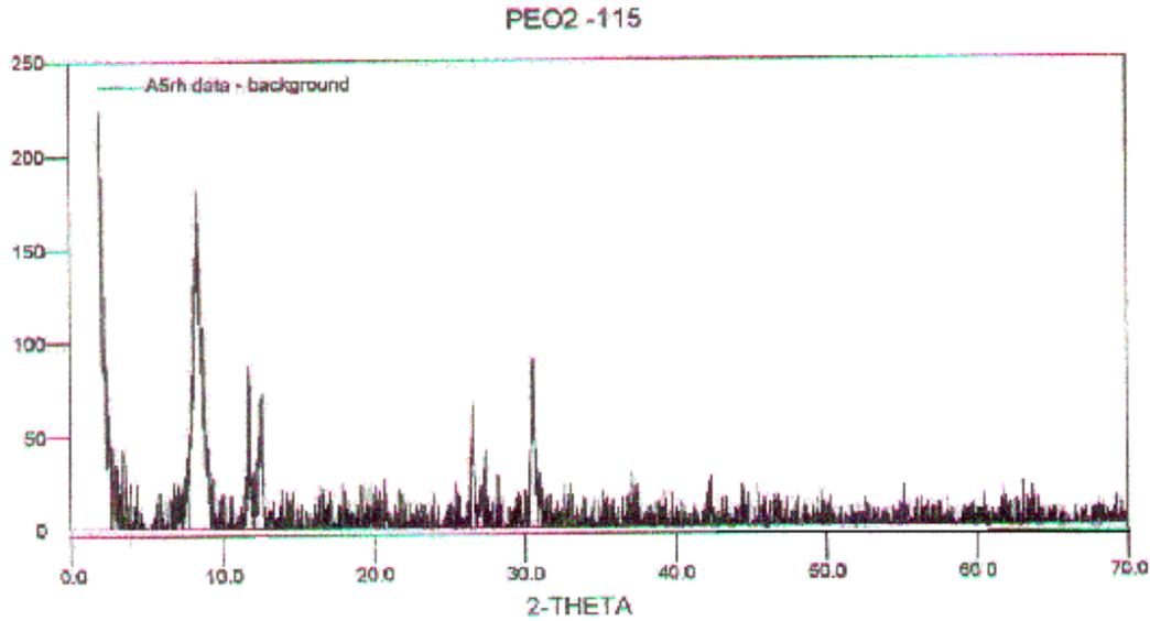
FIGURA 8. Difractograma de la caolinita, variedad halloysita.
