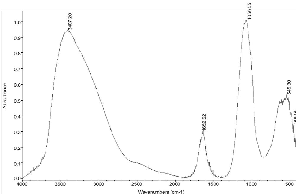
FIGURA 10. Espectro infrarrojo de la halloysita.
