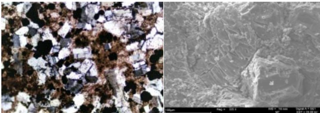
**FIGURA 3.** a) Aspecto al microscopio de las albitas neoformadas en niveles de la Formación Paja, afectados por procesos hidrotermales y; b) imagen al SEM de las albitas (al) presentes en nódulos albitizados, con evidencias de lixiviación (surcos en los cristales).
