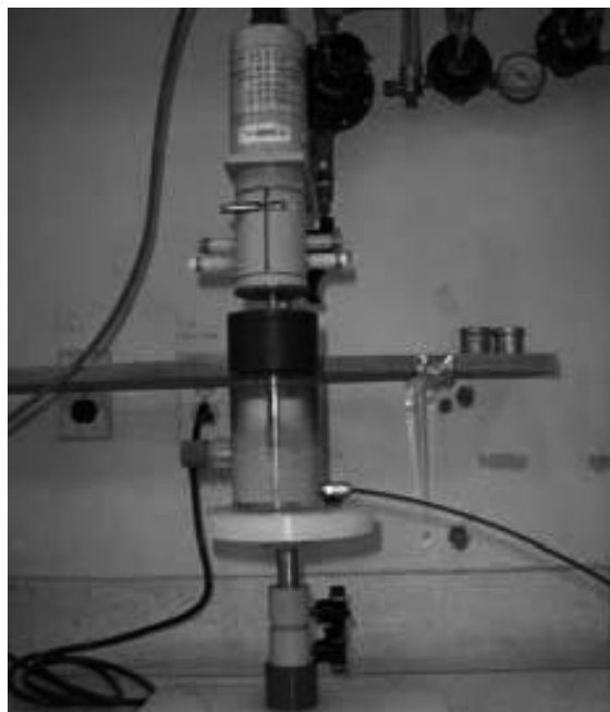
Figura 1. Celda empleada para ensayos de erosión.
