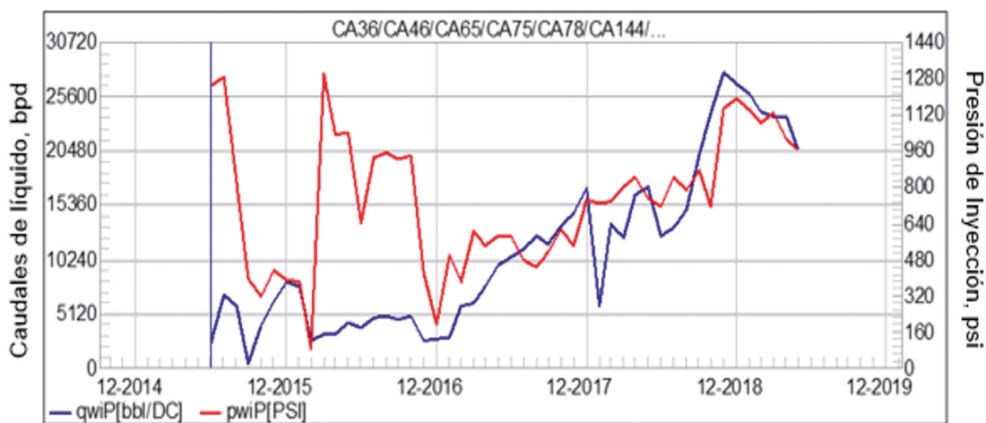
Figura 11. Caudal y presión promedio de inyección patrones existentes.
