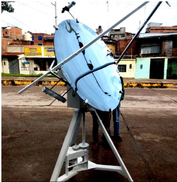
Figura 9. Prototipo del concentrador solar de disco
