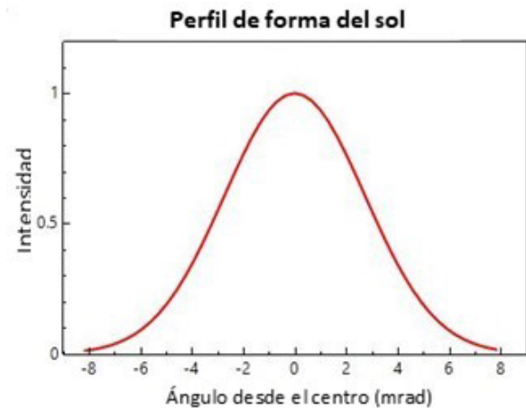
Figura 4. Perfil de la forma del sol (elaborado con SolTrace)
