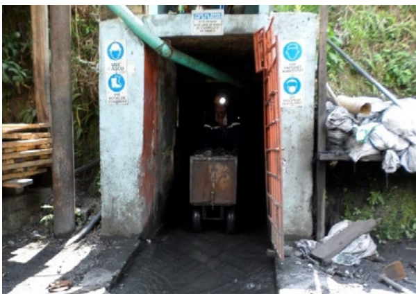
Figura 13. Proceso de retiro y transporte de material mediante carros mineros desde el fondo de mina hasta la entrada al túnel (Superficie – entrada al túnel).
