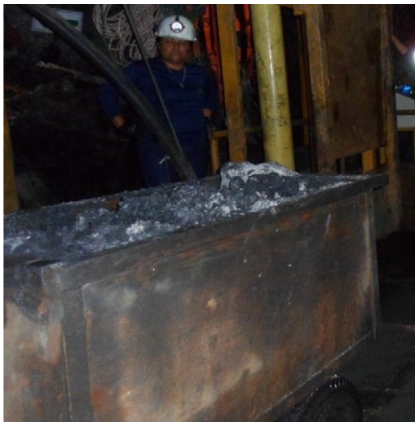
Figura 12. Proceso de retiro y transporte de material mediante carros mineros desde el fondo de mina hasta la entrada al túnel (Fondo de mina).
