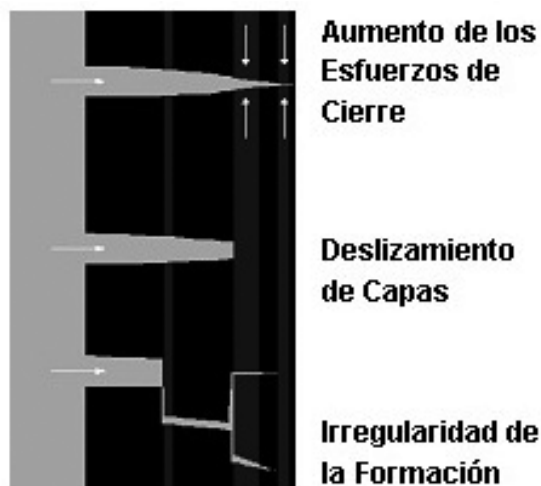
Figura 2. Variación de la geometría de fractura por cambios en la formación [2]
