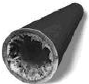
Figura 6. Escama de sulfato de calcio depositada en un tubo de producción.
