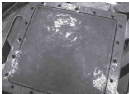
**Figura 5.** Medio poroso sellado con la capa de silicona y las tres capas de acetato.
