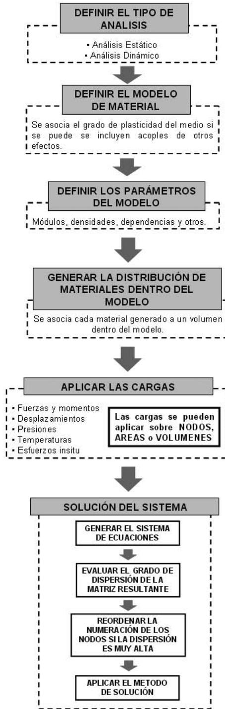
Figura 6. Metodología de carga del modelo para definición del análisis de esfuerzos y deformaciones
