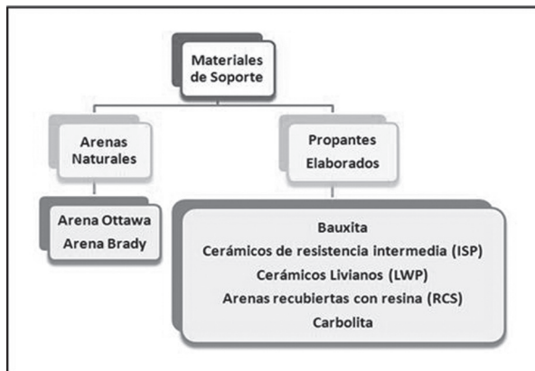
Figura 1. Clasificación de materiales de soporte de fracturas hidráulicas. Fuente: El autor
