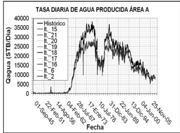
Figura 5. Tasas diarias de producción de agua de las mejores iteraciones del modelo de optimización de ajuste histórico automático.
