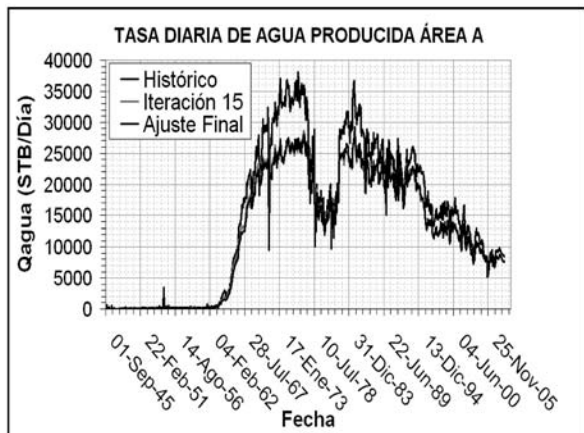
Figura 7. Tasa diaria de producción de agua obtenida del mejor modelo de ajuste histórico.
