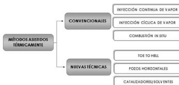
Figura 1. Clasificación de los métodos de recobro térmico
