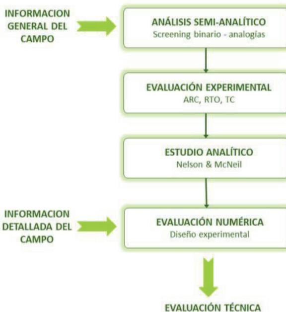
Figura 1. Proceso para seleccionar la inyección de aire como método de recobro mejorado
