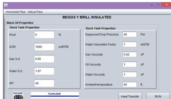
Figura 8. Datos de entrada correlación Beggs & Brill (flujo tubería Horizontal).
