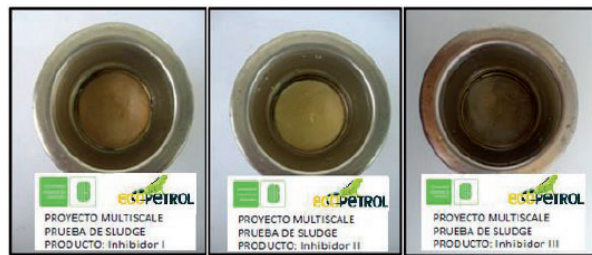
Figura 2. Prueba de Sludge (Inhibidores I, II y III)
