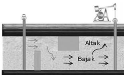
(c) Inyección de agua después de la gelación.
