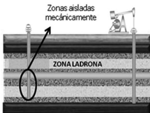
(a) Inyección de la solución gelante al yacimiento
