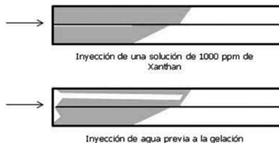
Figura 14. Digitación viscosa a través del banco de gel.
