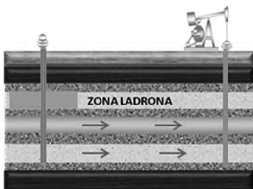
(c) Reanudación de la inyección de agua
