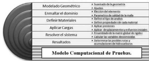
Figura 6. Metodología utilizada en el análisis Geomecánico de una formación geológica.
