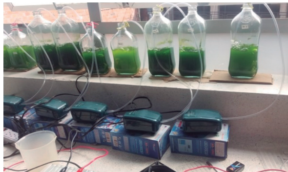
Figura 1. Reactores con mezcla entre microorganismos, agua destilada, corriente de aire.
