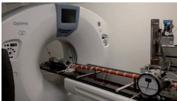
**Figura 3.** Sistema integrado de inyección de fluidos y escáner TAC, CFS 700 – CT.
