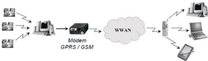
Figura 8. Uso de módem GPRS / GSM para el envío de datos a las redes celulares
