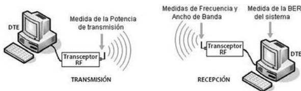
FIGURA 6. Diagrama general del plan de pruebas realizado en el sistema
