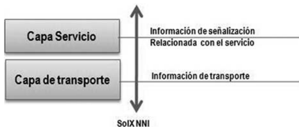
FIGURA 6. Arquitectura de Interconexión orientada a Servicios.
