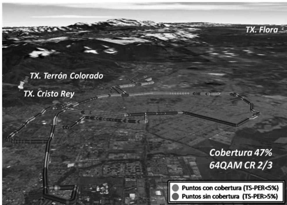
FIGURA 6. Cobertura DVB-T móvil 64QAM CR 2/3 en las rutas del sistema de transporte MIO-Cali.
