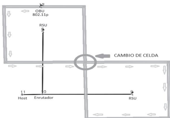
En este caso no se configura ningún protocolo de enrutamiento puesto que la herramienta de simulación no permite su configuración cuando se utilizando nodos 802.11p y por tanto se compara bajo iguales condiciones en las dos enmiendas.
