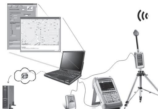
FIGURA 4. Configuración del sistema de medición
