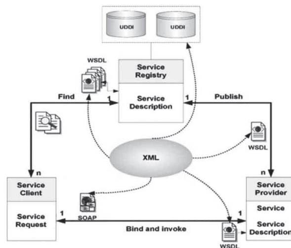
FIGURA 3. Modelo de referencia de un servicio web W3C.
