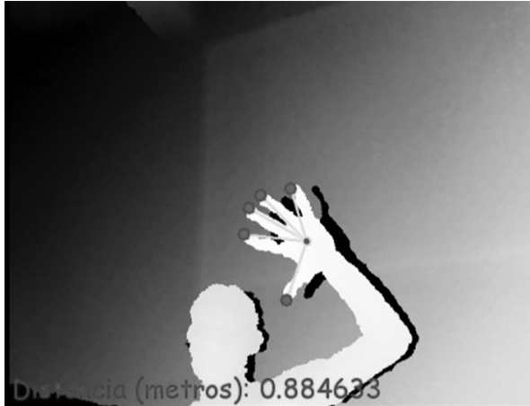
FIGURA 11. Ejecución del algoritmo a 0,88m el algoritmo tiene una efectividad del 100% detecta los 5 dedos de la mano.
