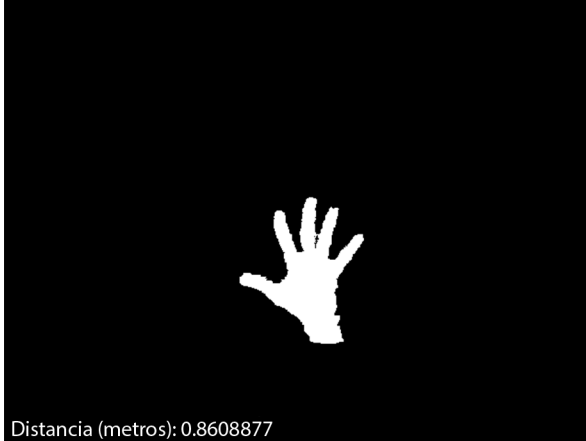
FIGURA 3. Segmentación y binarización de la imagen de la mano.
