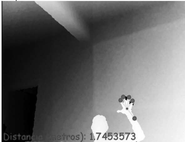
FIGURA 12. Ejecución del algoritmo a 1,74m el algoritmo tiene una efectividad del 50% por lo que no es optimo al detectar los dedos de la mano.
