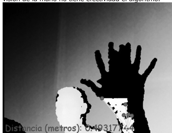
Figura 10. Ejecucion del algoritmo a 0,49m no tiene vision de la mano no tiene efectividad el algoritmo.
