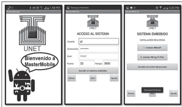
El modo manual, permite el control de forma manual sobre las electroválvulas y el motor, presentes en el proceso, para activar o detener en tiempo real y de acuerdo con la lógica de control, las variables del sistema. En el modo automático se puede iniciar o detener el proceso y supervisarlo en tiempo real. En la Figura 14 se aprecian las interfaces de selección del modo y la ejecución del modo manual, utilizando un teléfono real Samsung Galaxy SIII mini, a través de la red Wi-Fi.
