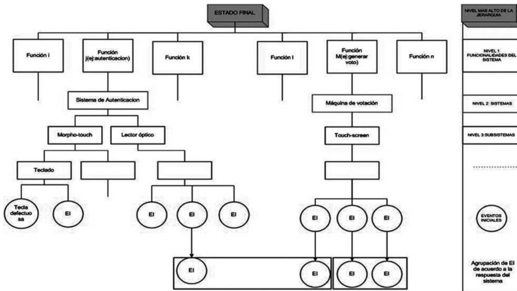
FIGURA 4. Estructura general de un diagrama de secuencia de eventos
