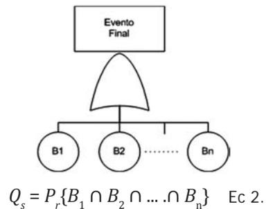
FIGURA 8. Diagrama de flujo del enfoque probabilístico
