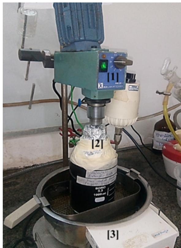
Figura 5. Montagem experimental para a extração dos CNCs pelo método APS. [1] Agitador; [2] Sistema reacional; [3] Banho de aquecimento.
